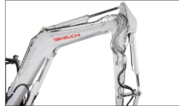
4 Steuerkreise, davon 3 proportional gesteuert, regulierbare Literleistung.
