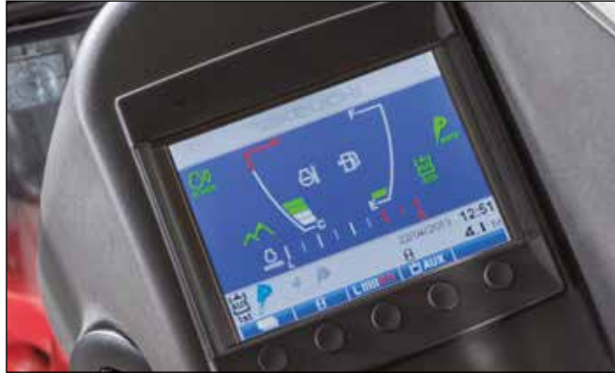
Display mit optischen und akustischen Überwachungseinheiten. ECO-Betrieb zur Erhöhung der Wirtschaftlichkeit und Verringerung des Dieserverbrauchs.
