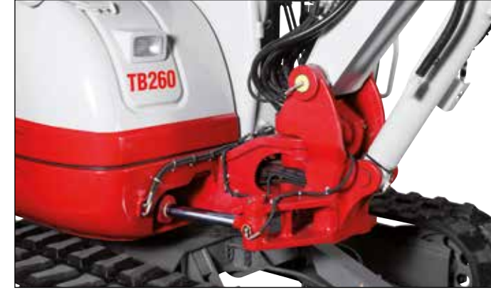
Robuster Schwenkbock mit Schwenkzylinder. Hubzylinder mit Endlagendämpfung. Überlastwarneinrichtung und Schlauchbruchsicherung serienmäßig.
