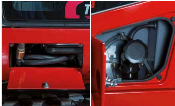
Zusätzliche Öffnungskappen für optimalen Zugang zu Betankungspumpe und Tankdeckel.
