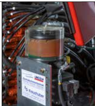
Mengen-gesteuerte Zentralschmieranlage mit Leerstandsmeldung
