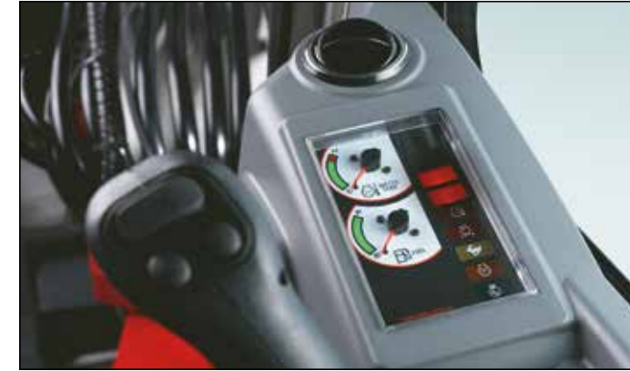
Armaturenbrett mit hör- und lesbaren Warnungen im Falle einer Störung während des Betriebes.
