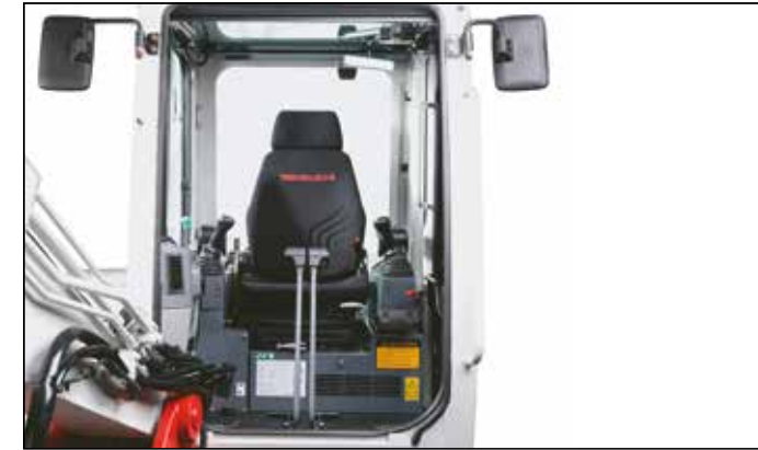
Schallgedämpfte, vibrationsarme Komfortkabine mit Luxussitz (wetterfeste Ausführung bei Modellen mit Überrollbügel) für ermüdungsfreies Arbeiten.
